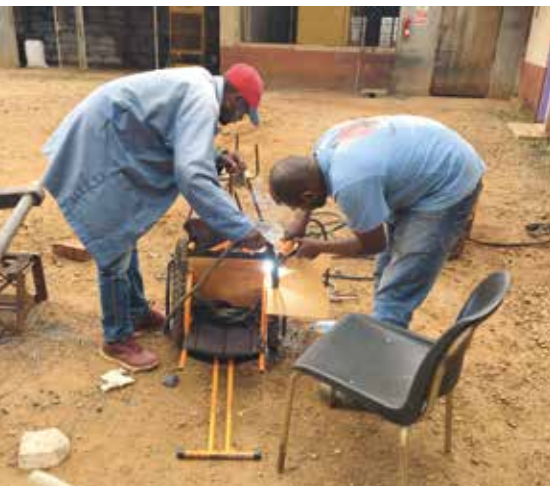
Ein Rollstuhl wird aus vorhandenen Materialien gefertigt. Der lehmige Boden erfordert großprofilige Reifen.
